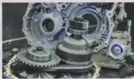
Разбираем китайский вариатор WLY для Лады Весты 56
